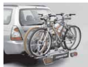
39 Polkupyöräteline asennetaan vetokoukkuun E361ESA600
