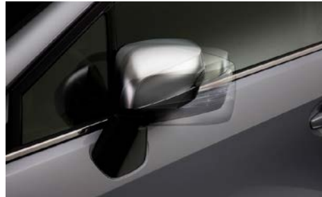
6 Automaattinen peilintaitto SEECAL3100 Peilit taittavat korinmyötäisiksi lukittaessa ja aukeavat, kun syytysvirta kytketään. Can only be mounted on cars with electrical folding door mirrors.
