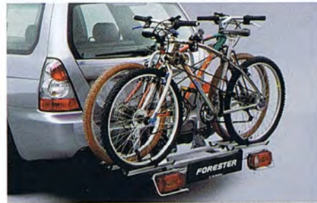
46 Polkupyöräteline asennetaan vetokoukkuun E361ESA600 W
