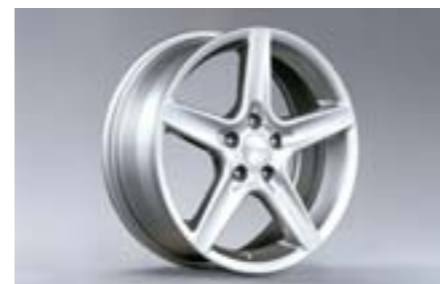
24 Kevytmetallivanne 5-puolainen (17"), Antrasiitti SESLAG4000 E 17x7JJ offset 55 215/45R17
