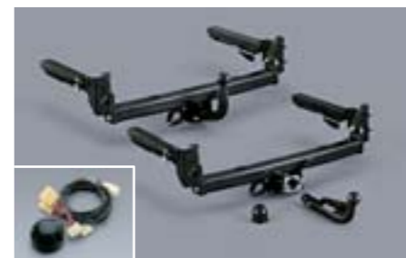
47 Vetokoukku, kiinteä / irrotettava Katso soveltavuuslista W Maksimi vetopaino 2000 kg.
