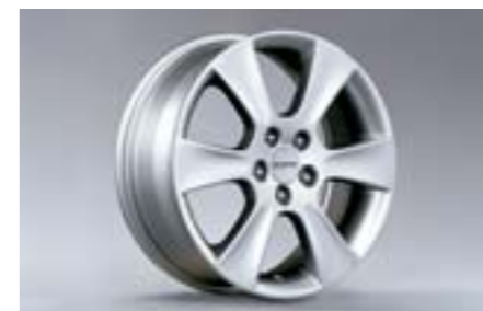
26 Kevytmetallivanne 6-puolainen (16") SECWFE4000 E 16x6.5JJ offset 55 205/55R16
