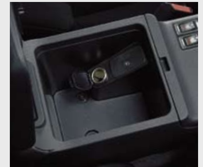
Audio/Visual-liitin ja 12 voltin pistorasia keskikonsolissa
